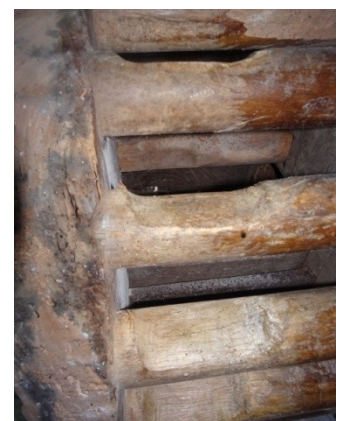
Het versleten aandrijfswiel van de maalsteen
